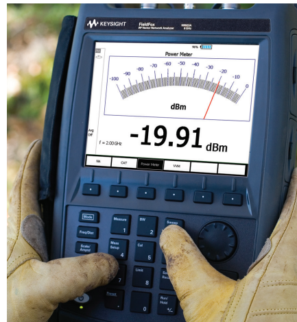
Power meter display
